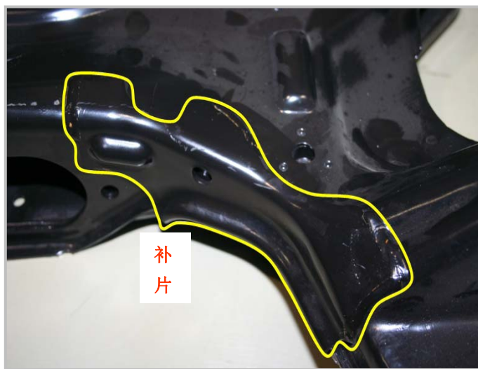
图 5.20 基于同样副车架的某款运动型轿跑副车架薄弱点改进方案
