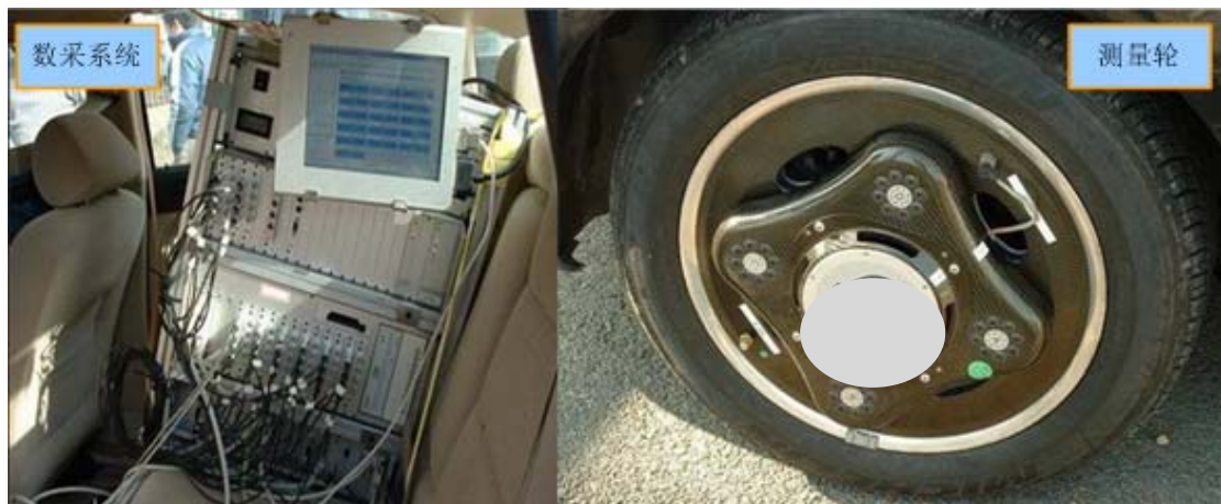
图 3.4 车轮六分力系统和数据采集系统
