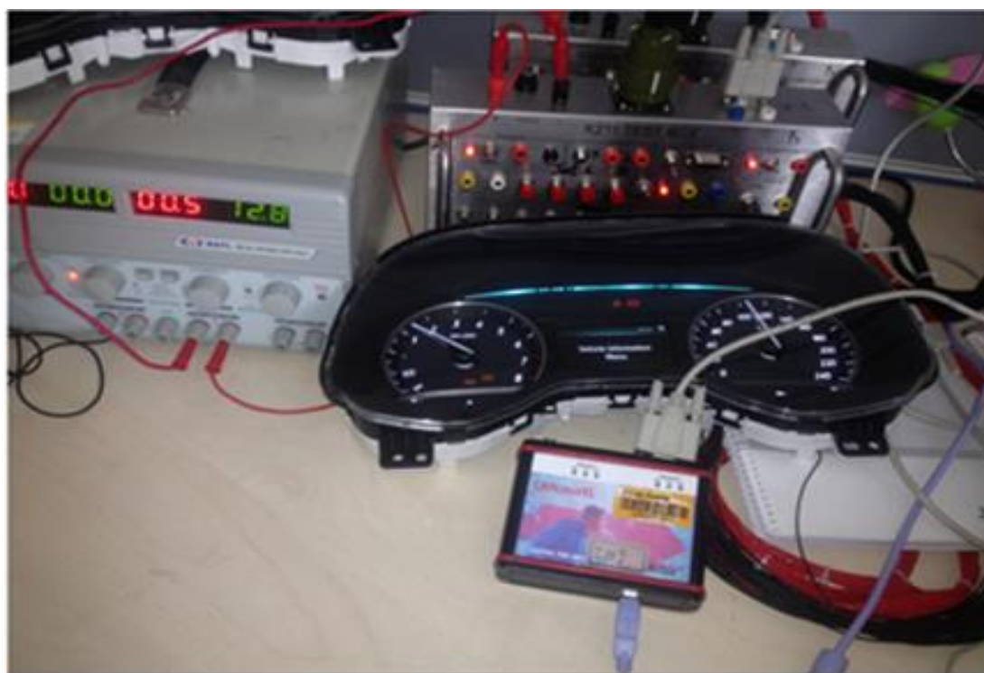
图 6.2 仪表集成测试台架
