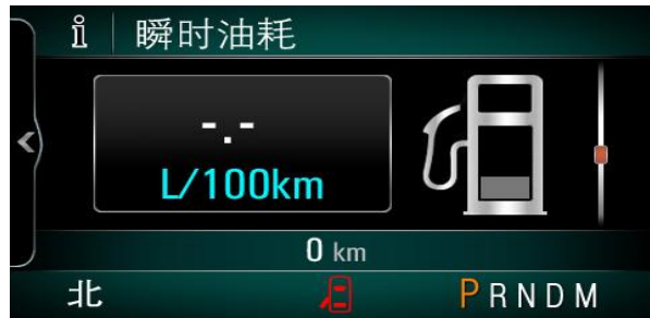
图 4.19 瞬时油耗在组合仪表上的显示
