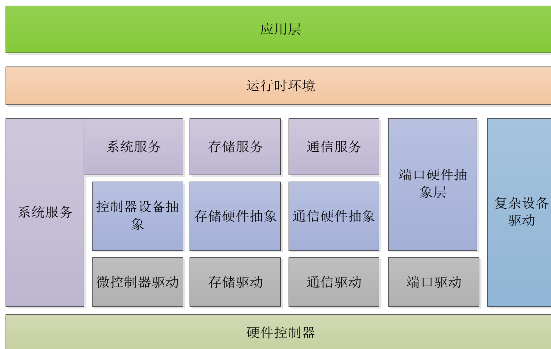
图 2.3 AUTOSAR 软件架构示意图
